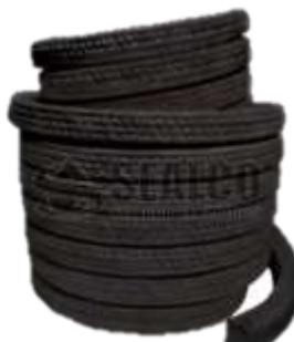
Se fabrica con hilos PTFE grafito, ideal para estandarizar las plantas. Se utiliza con solventes, aceites, gases, ácidos fuertes, álcalis fuertes y derivados del petróleo, etc. No usar con oxidantes fuertes. No raya ejes
