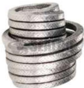
Fabricada con hilos de grafito expandido micrónico vermiculado obtenido de un proceso de nanotecnología, las fibras se multitrenzán para conformar una empaquetadura compacta, uniforme, estable térmicamente con altísima conductividad térmica y súper bajo coeficiente de fricción; reforzada en la esquinas y en el interior con hilos de carbón estructural que proveen alta resistencia mecánica para soportar
