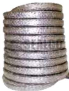
Hilos de carbón de alta resistencia, refuerzan las esquinas para soportar mayores presiones sin necesidad de anillos de soporte. Soportan 3000°C en atmósferas reductoras, 1000°C en vapor y 480°C en atmósferas oxidantes.
