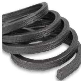
Empaquetadura fabricada con hilos de PTFE con partículas submicrónicas de grafito. No raya ejes. Es utilizado con aceites, ácidos fuertes, gases, álcalis fuertes, derivados del petróleo, solventes, etc. No usar con oxidantes fuertes
