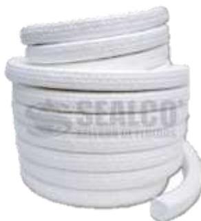
Empaquetadura de PTFE puro, es impregnada en aceites especiales. Posee una excelente resistencia a los productos químicos tales como ácidos fuertes, álcalis y solventes. No se recomienda su utilización con flúor y metales alcalinos derretidos.
