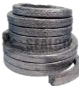
Hilos de grafito flexibles expandido sin aglutinantes con inserción de inconel multi trenzados para conformar una empaquetadura de excelente lubricidad, alta resistencia térmica y mecánica, su refuerzo de inconel le permite soportar mayores presiones sin necesidad de
