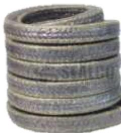
Hilos de grafito reforzados con carbón son multitrenzados conformando un tejido que se refuerza con hilo aramidico en las esquinas. Empaquetadura que ha sido diseñada especialmente para ser utilizada al servicio con bombas reciprocantes, altas presiones y en el manejo de abrasivos.
