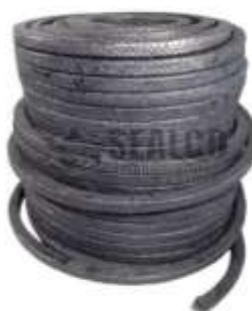
Hilos de aramida impregnados con grafito y PTFE son trenzadas para tomar una empaquetadura altamente resistente a los abrasivos sin rayar ejes. Posee altas resistencia mecánica y la resistencia química de las aramidas.
